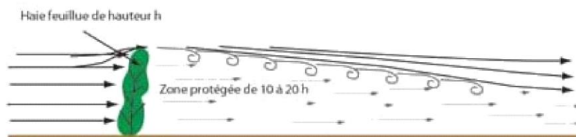
Figure 33 : Effet d'une haie sur la dispersion des odeurs
